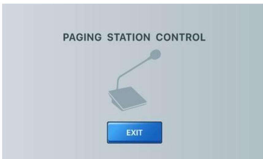
Interfejs sygnalizacji nadpisania stacji wywoławczej w jednostce centralnej
